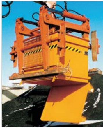
Type BC met steentangontgrendeling
