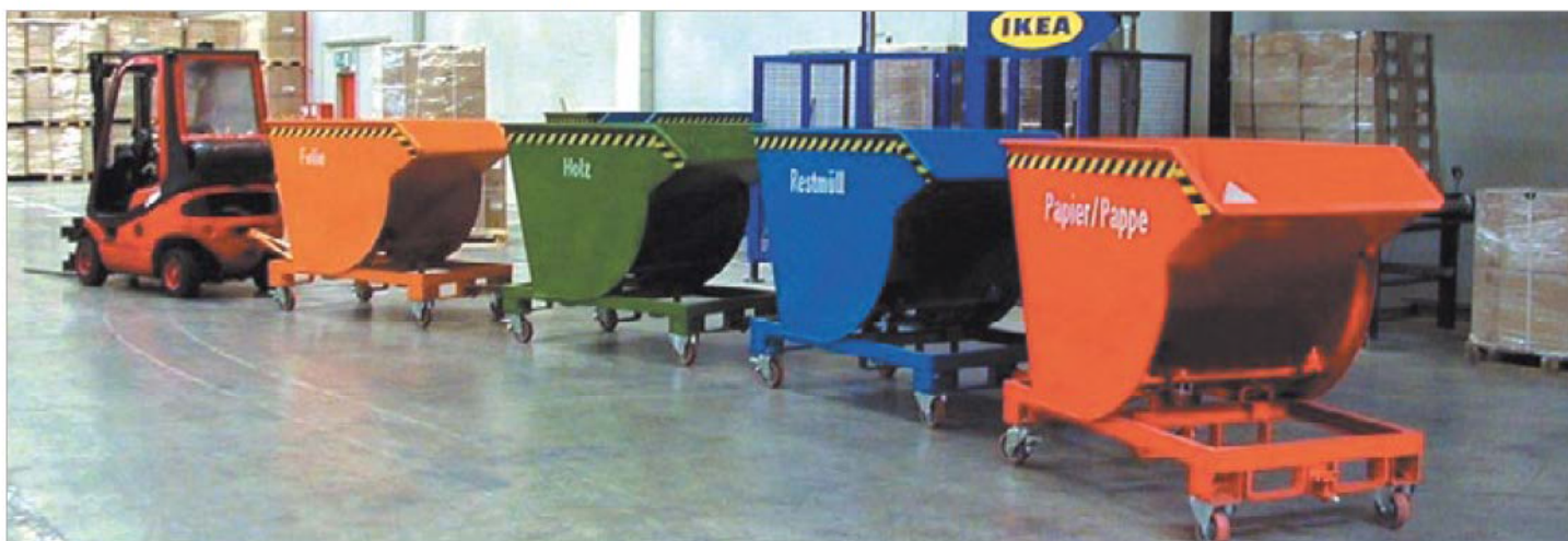
Type BKM met wielen en aanhangerinrichting met dissel
