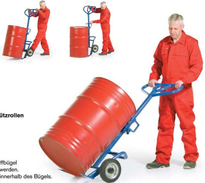
Die Fasskarren sind geeignet für alle 200-Liter-Fässer mit umlaufendem Rand. Sie werden in einer robusten Stahlschweißkonstruktion gefertigt. Über den großen Griffbügel kann die Karre besonders leicht angekippt und geführt werden. Die Hände des Bedieners liegen dabei immer geschützt innerhalb des Bügels.
