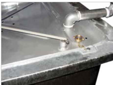
Peilstok voor vulstandcontrole
