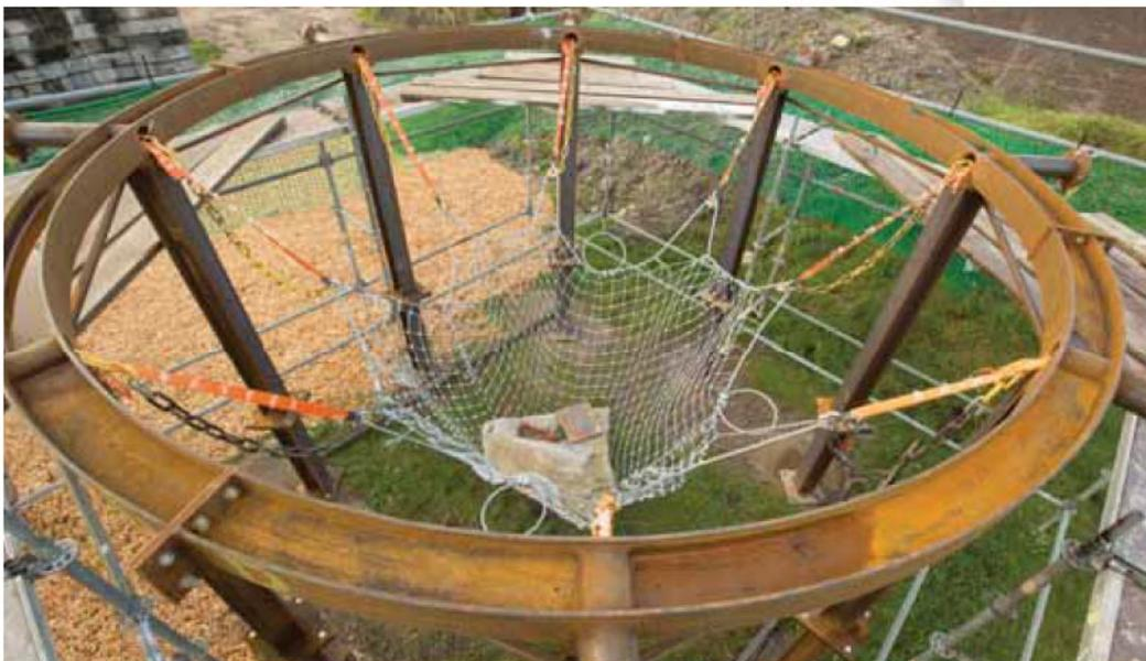
Ist-Zustand nach dem Fallversuch, mit ausgelösten „Dämpfern“
