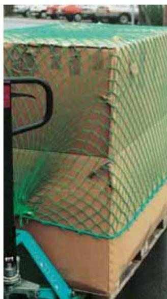
Sicherungsnetz aus festem Netz Tuch!
