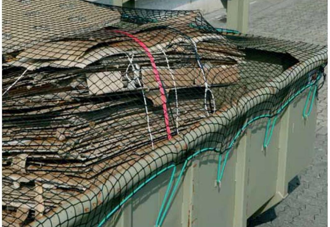
Abdecknetz mit Gummi-Spannleine (s. S. 20)
