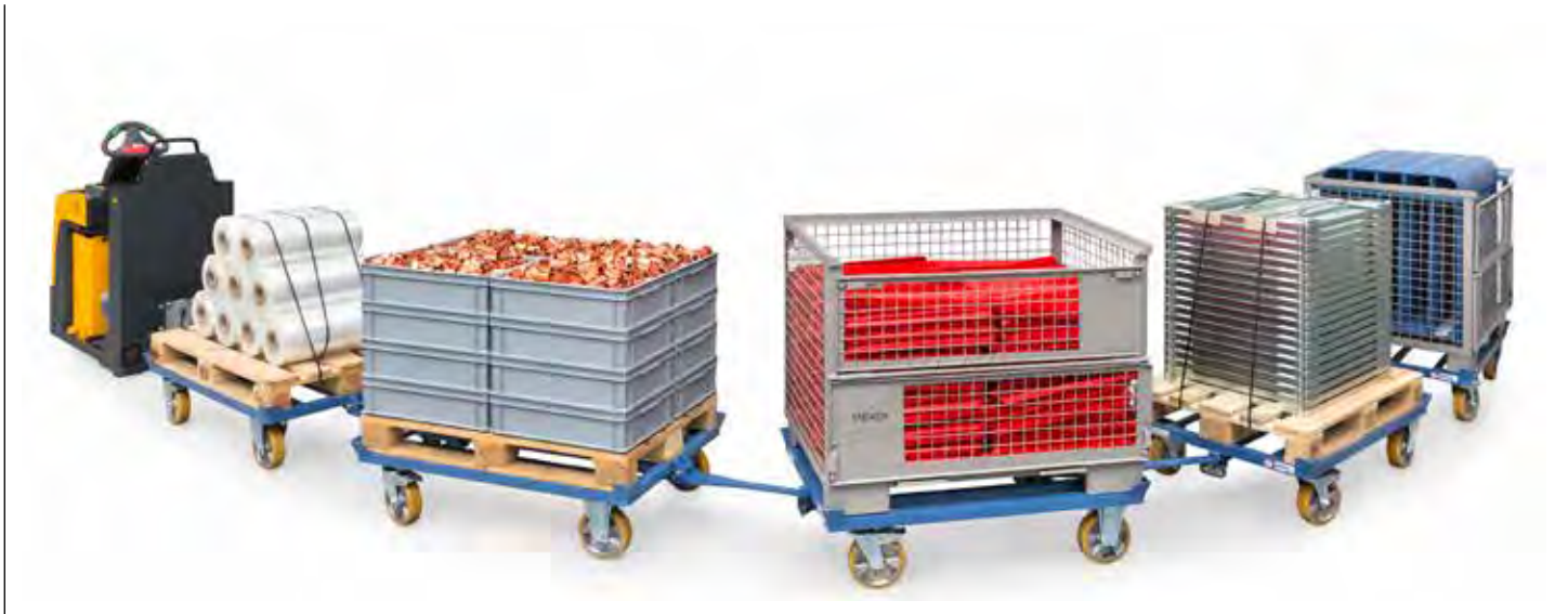
Elektro routetrein met trekker en 5 palletonderwagens
