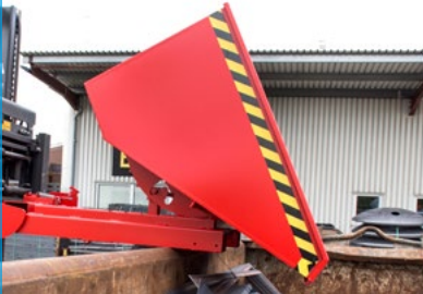
Afrolmechanisme met automatische ontgrendeling
