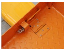
Afglijdbeveiliging voor stapelaar
