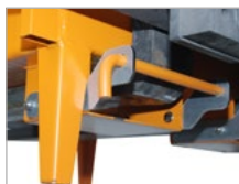
Afglijdbeveiliging middels boutvergrendeling voor de heftruck
