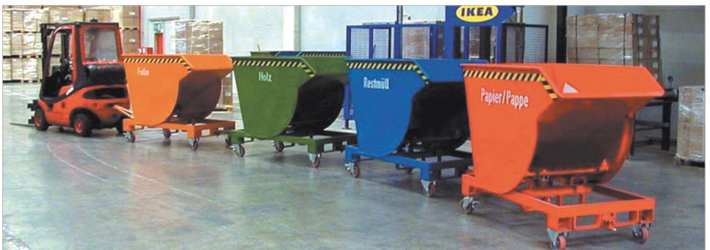
BKM met wielen en aanhangerinrichting met dissel
