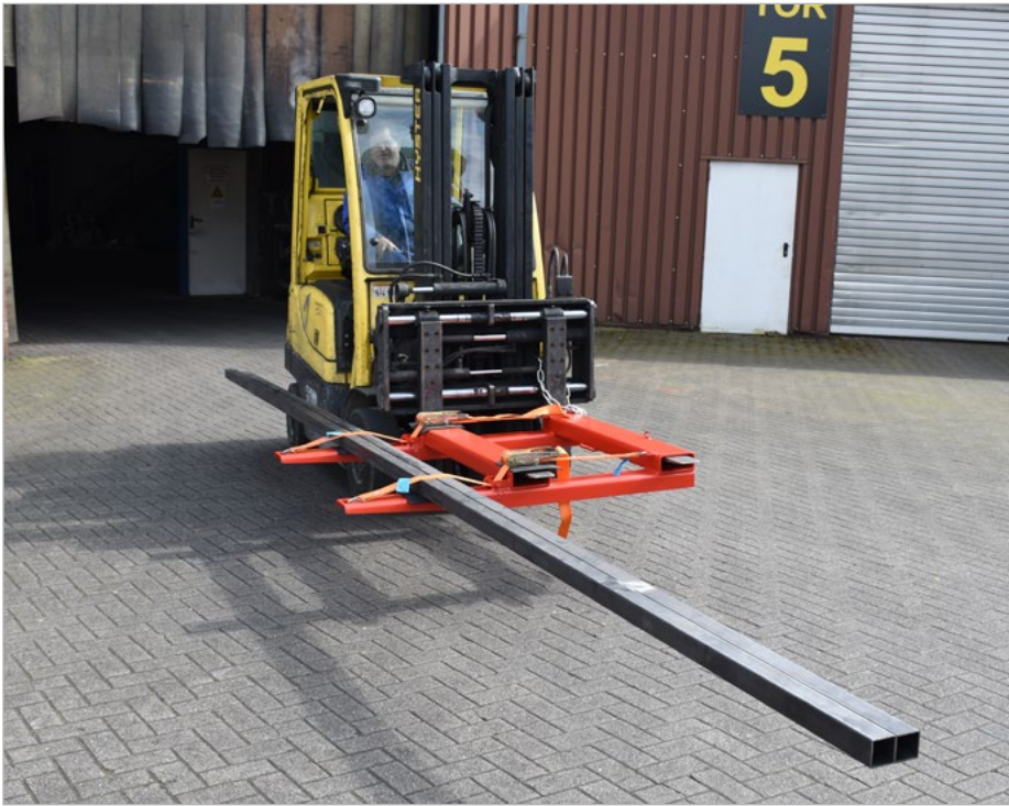
Opnamepositie voor transport b.v. door poorten en gangen
