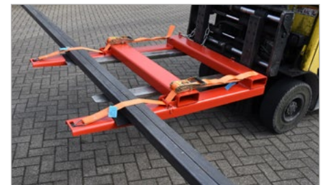
Opnamepositie voor laden en lossen
