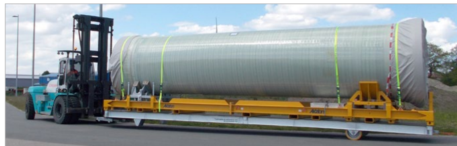
Voor het transport van extreem zware en volumieuze delen: lengte 12 meter, draagkracht 20t
