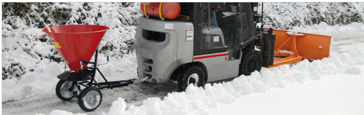
Sneeuwschuiver SCH-G in combinatie met STW 100
