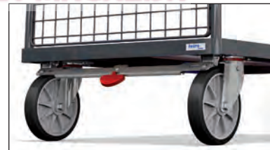
TOTALSTOP – het fetra centrale remsysteem Met slechts één voetbeweging wordt de wieldraaiing en de zwenkbeweging van beide zwenkwielen geblokkeerd. Het rempedaal blijft altijd in het zicht van de gebruiker.
